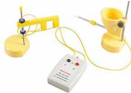
L'Auto Trickler ha tutte le caratteristiche dell'originale Dandy Trickler con l'aggiunta di un spegnimento automatico. Attivato da un sensore di luce, lo spegnimento interrompe immediatamente il flusso di polvere, una volta raggiunta la carica di peso impostato. Funziona sia con bilance ad ago (tipo 5.0.2/5.0.5) e bilance digitali. NOTA: Non utilizzare con polvere nera o sostituti polvere nera.
