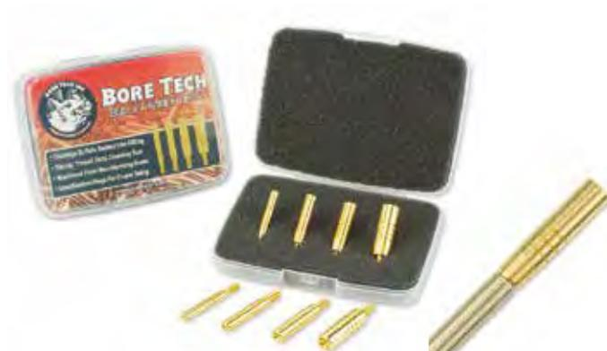
Kit di 4 inserti per la rimozione delle palle in canna. Questi inserti sono stati studiati e realizzati appositamente per essere usati sulle bacchette a passo americano per la rimozione delle palle incastrate nel throat o nelle rigature, senza rovinare la filettatura della bacchetta. Il kit permette di rimuovere palle dal calibro .17 al .50.
