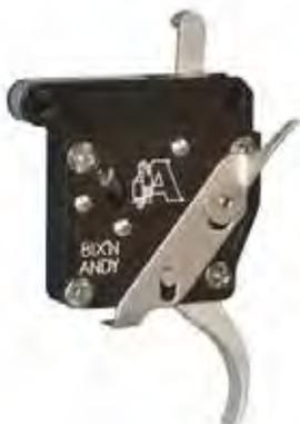
Scatto con sicura destra e SENZA sgancio otturatore regolabile da 30 a 700 grammi tramite le tre diverse molle (fornite a corredo dello scatto). Può essere montato su Remington e tutti i custom la cui basetta è stile Remington.
