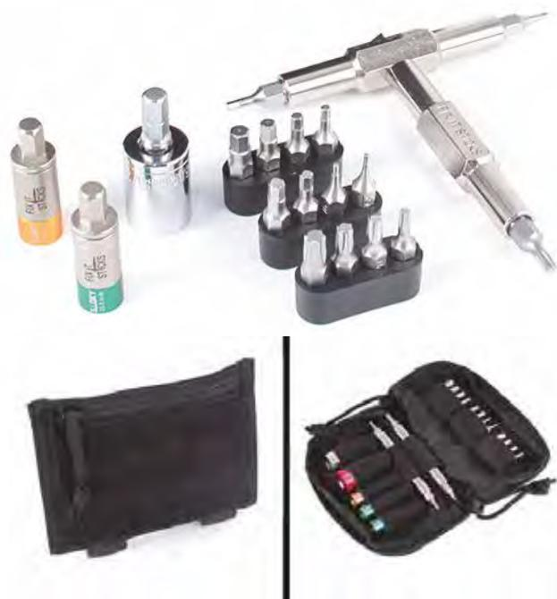
Tutti i kit multi-utensile comprendono un set di Fix It Sticks oppure una chiave T-Way, almeno una paio di Torque Limiters (limitatori di coppia), 16 Bits intercambiabili, due adattatori: 1/2" Socket + 1/4" Bit, ed una custodia in cordura Deluxe. Sono leggeri, compatti, tascabili e perfetti per cacciatori e tiratori che necessitano anche di lavorare direttamente sul campo.
