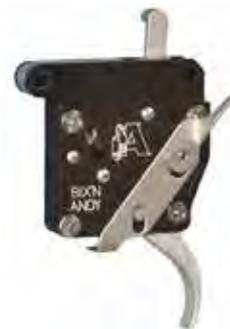
Scatto con sicura destra e sgancio otturatore regolabile da 30 a 700 grammi tramite le tre diverse molle (fornite a corredo dello scatto). Può essere montato su Remington e tutti i custom la cui basetta è stile Remington
