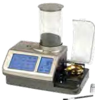
Accurate a un decimo di grano, la GEN 5 dispensa tutti i tipi di polvere senza fumo a due grani per secondo. Inoltre, è dotata di una funzione di ripetizione automatica che fa partire una nuova carica ogni volta che il piattino viene rimesso sulla bilancia. Sulla nuova base completamente digitale si sono risolti i problemi comunemente riscontrati nei vecchi modelli, il sistema è stato migliorato in tutti i sensi, tre minuti di riscaldamento, una
