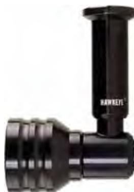
Questo praticissimo accessorio va utilizzato sui boroscopi Hawkeye. Aiuta nella visione spostando la visuale di 90° ma ruotando l'immagine in modo da compensare la rotazione. Dotato anche di una regolazione della messa a fuoco indipendente che ne facilita la posizione durante l'ispezione dell'arma.
