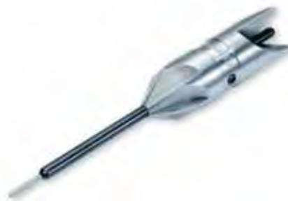
Questo strumento pilotato per la svasatura interna, garantisce una perfetta lavorazione all'interno del colletto con un angolo di 15°. L'asta pilota è regolabile per le diverse lunghezze dei bossoli e assicura la concentricità della svasatura nel diametro interno. Utilizzabile dal calibro .22 al .45.
