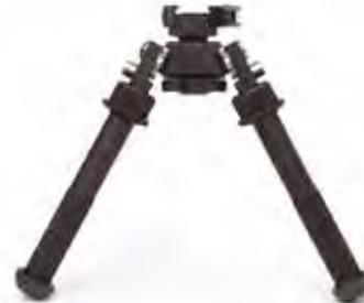
Il bipiede BT10-LW17 V8 Atlas Bipod si monta direttamente su tutte le slitte Picatinny 1913 style, mediante la leva ADM-170-S included. È composto di alluminio 6061-T6 che è rivestito da uno strato ricoprente molto resistente Mil-Spec Type III, e gli altri componenti sono tutti in acciaio inossidabile. Disponibile solo in colore nero.
