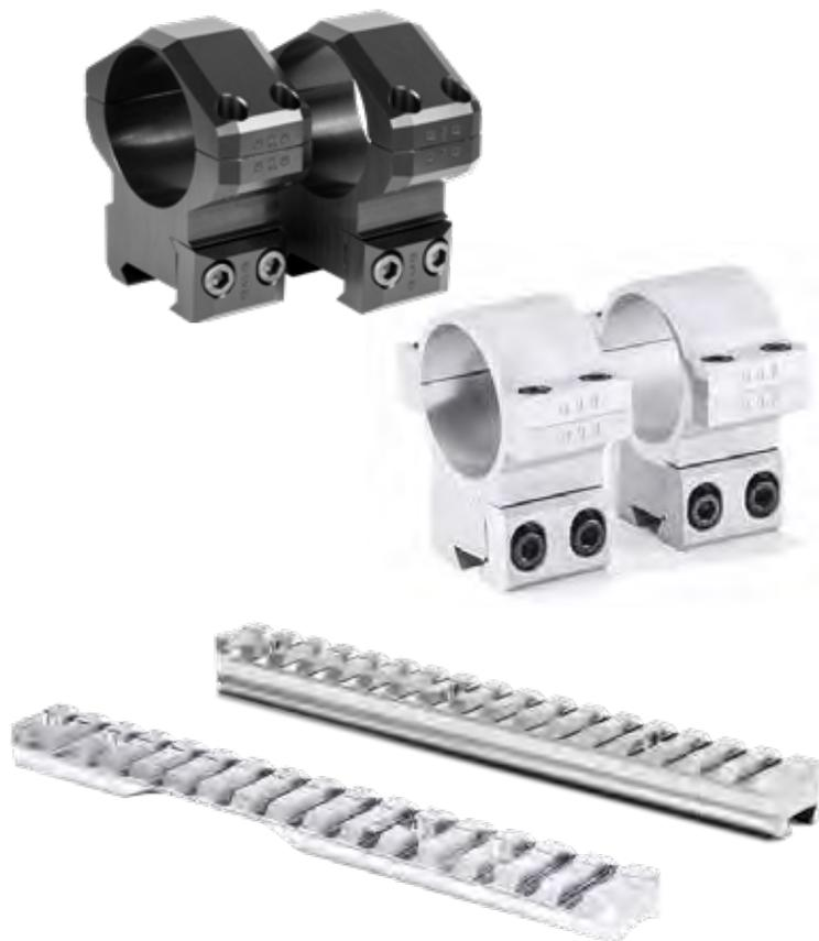
Tutti gli anelli per cannocchiali Kelbly sono fatti in alluminio aeronautico 2024, che li rende leggeri, duri e resistenti. Nel processo di manifattura una barra lunga 12 pollici viene forata con precisione e poi fissata ad un mandrino, sul quale vengono lavorati molti anelli alla volta sulla barra stessa. Due anelli consecutivi diventano un paio, e questo assicura minime variazioni di tolleranza nello stesso paio. Si elimina così la necessità di lappare gli anelli su basi ben allineate.
