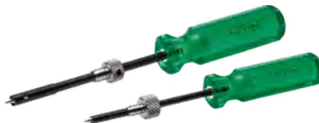
Durante il processo di produzione del bossolo, alcune piccole particelle di sbavatura sono spesso lasciate all'interno del bossolo in corrispondenza del foro di vampa. Tali particelle possono causare l'accensione irregolare dell'innesco. La Redding produce due differenti strumenti per la rimozione delle bave dal foro di vampa. Entrambi gli utensili utilizzano i pilot stop che sono elencati alla pagina successiva.
