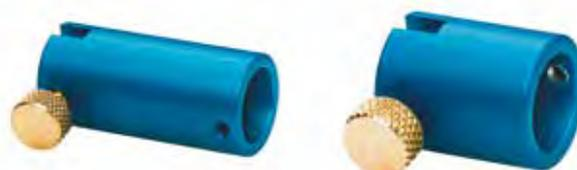
Questo supporto è realizzato per essere fissato sul calibro per la misurazione delle munizioni o della spalla. Con la pratica vite in ottone si blocca il body al becco del calibro, senza il rischio di rovinarlo. Nella parte inferiore invece si possono inserire le boccole per la misurazione dell'ogiva oppure quelle per la misurazione della spalla, bloccandole con il grano posto lateralmente.
