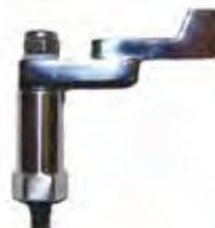
Attrezzo di fondamentale importanza per l’uso del tornietto Wilson. Applicabile sull’apposita base permette di tenere fermo il case holder durante tutte le lavorazioni del bossolo.
