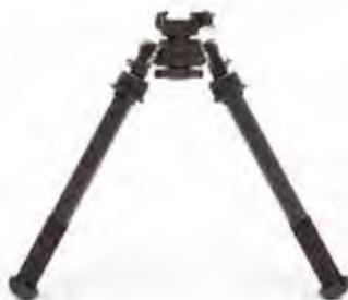
Il bipiede BT46-LW17 PSR (Precision Sniper Rifle) Atlas Bipod si monta direttamente su tutte le slitte Picatinny 1913 style, mediante la leva ADM-170-S inclusa. E' composto di alluminio 6061-T6, ad eccezione della parte interna delle gambe che è fatta di alluminio 7075-T6. Il tutto rivestito da uno strato ricoprente molto resistente Mil-Spec Type III. e gli altri componenti sono tutti in acciaio inossidabile. Disponibile solo in colore nero.
