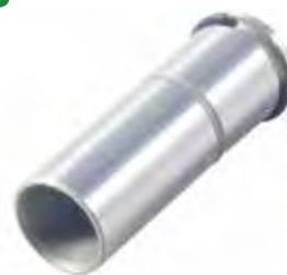
La maggior parte delle palle VLD o Hybrid hanno un profilo di ogiva molto più lunga delle classiche palle HPBT, questo significa che con i dies muniti di seating stem tradizionale la punta va a contatto con la porzione alta. Con questo inserto invece viene correttamente trattenuta a circa metà ogiva. Grazie a questo inserto specifico le palle VLD o Hybrid troveranno il giusto appoggio per essere correttamente inserite nel bossolo. Utilizzabile solamente su dies Redding della serie Competition.
