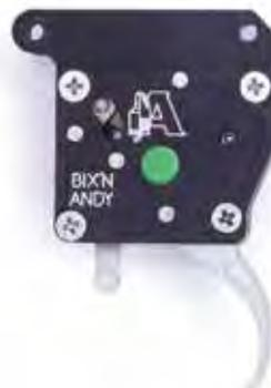
Scatto con sicura in basso a destra e SENZA sgancio otturatore regolabile da 30 a 700 grammi tramite le tre diverse molle (fornite a corredo dello scatto). Può essere montato su Remington e tutti i custom la cui basetta è stile Remington.
